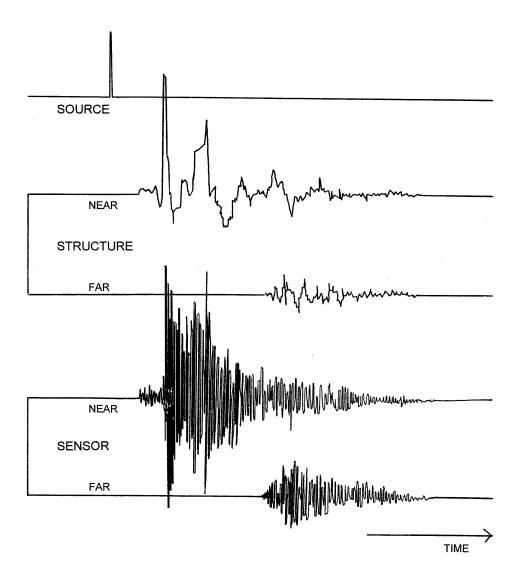
传感器的种类: 谐振式高灵敏度传感器是声发射系统中使用最多的, 其参数技术的基础归结于两个基本假设, 即声波在材料中传播时波形和波速都是不变的
